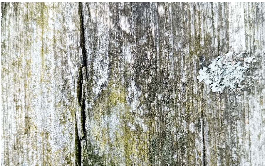
Figur 7.3 NTR B klassificerat virke efter 12 års användning ovan mark i väderutsatt läge där yttlig påväxt koloniserat virkesytan. Skyddet gäller mot rötsvampar och inte yttlig påväxt vilket tydligt kan observeras (foto: M Theorin).
