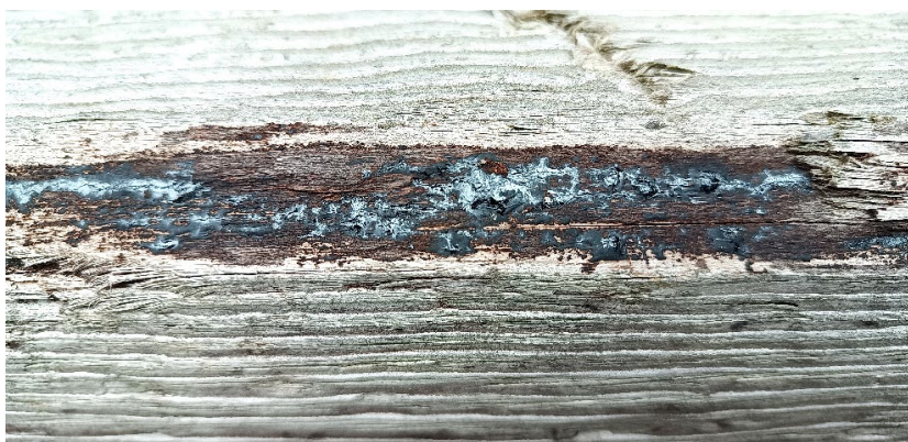
Figur 7.2 Kreosotbehandlat virke har, trots allvarliga risker för skador på människors hälsa och miljön, godkännande att användas utvändigt i linjenätsstolpar (foto: M Theorin).
