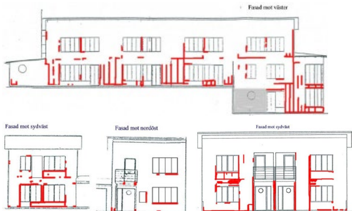
Figur 3.1 Exempel på skadornas utbredning efter friläggning in till träregelstommen (flerbostadshus). Röd färg markerar synlig mikrobiell påväxt eller rötskador. Grå färg markerar betongstomme (från Jansson 2011 RISE).
