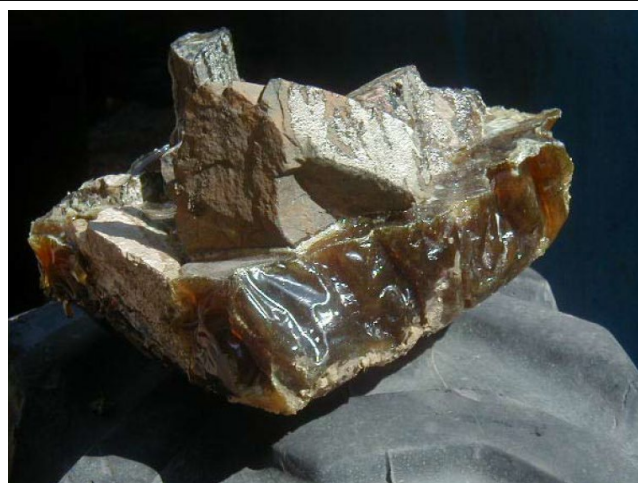
Figur 7.5 Bergfragment med PU-resin inbäddat efter en bergförstärkningsåtgärd (från Arndt et al. 2008).
