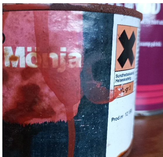
Figur 7.1 Exempel på äldre rostskyddsfärg med innehåll av blymönja (blysvlfat) användes för att rostskydda metallbeslag (foto: M Theorin).
