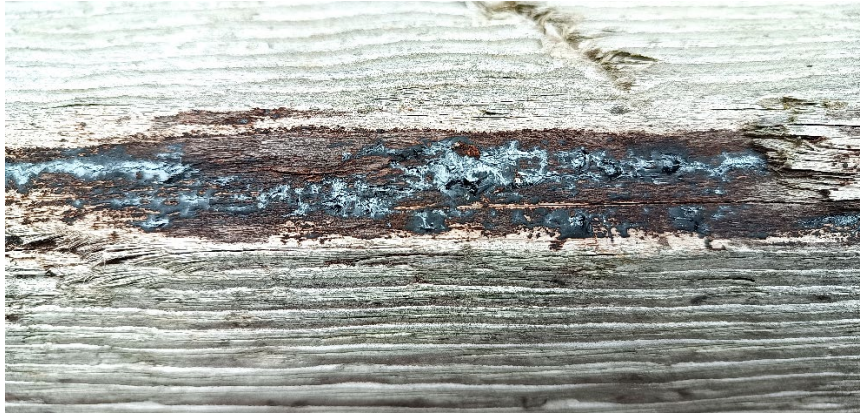
Figur 7.2 Kreosotbehandlat virke har, trots allvarliga risker för skador på människors hälsa och miljön, godkännande att användas utvändigt i linjenätsstolpar (foto: M Theorin).
