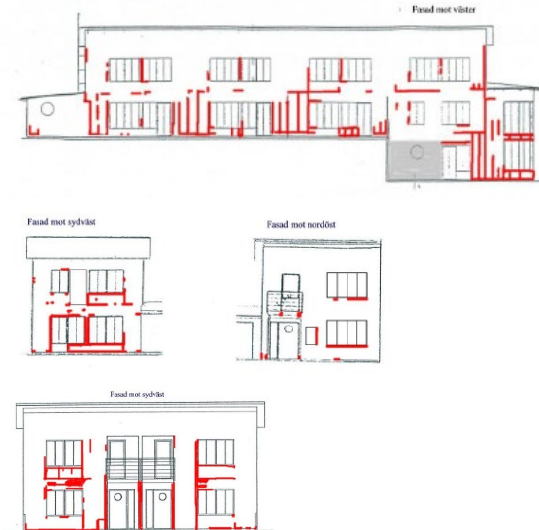
Figur 3.1 Exempel på skadornas utbredning efter friläggning in till träregelstommen (flerbostadshus). Röd färg markerar synlig mikrobiell påväxt eller rötskador. Grå färg markerar betongstomme (från Jansson 2011 RISE).
