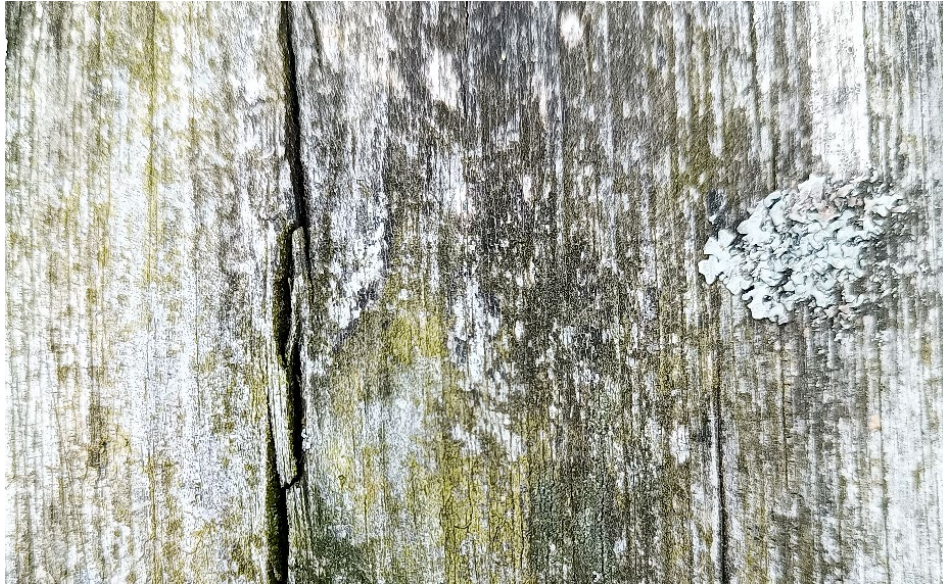
Figur 7.3 NTR B klassificerat virke efter 12 års användning ovan mark i väderutsatt läge där yttlig påväxt koloniserat virkesytan. Skyddet gäller mot rötsvampar och inte yttlig påväxt vilket tydligt kan observeras (foto: M Theorin).
