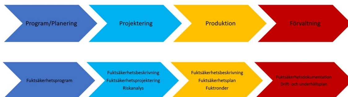
Figur 5.1.1 Översiktsbild av nyckelmomenten i en fuktsäker byggprocess enligt ByggaF. (Källa: E Gustafsson)
