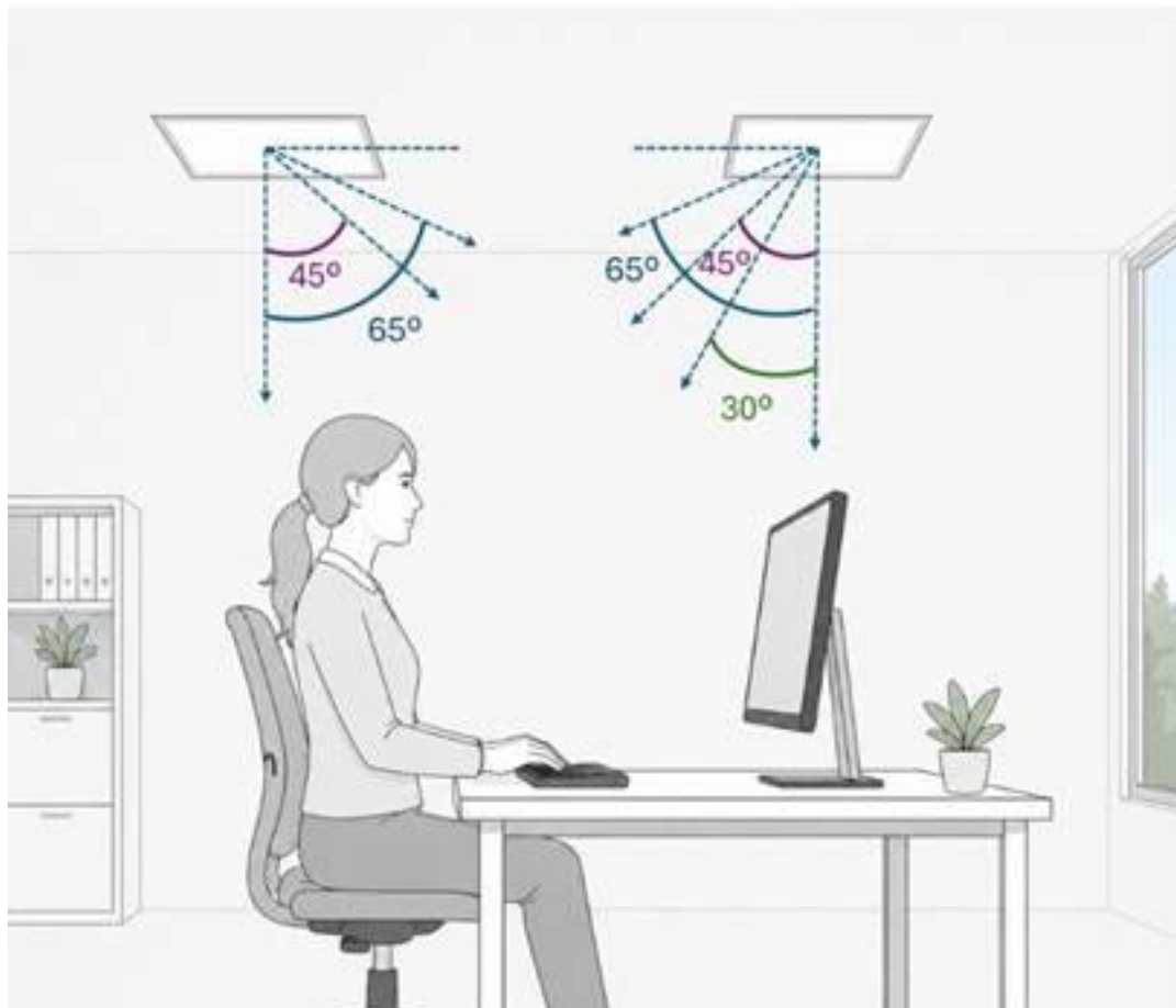
Figur 7.2 Armaturer med vinklar som riskerar bländning och reflexer, större än 65^\circ vinkel ska inte finnas i en kontorsmiljö pga. reflexer i skärmen, men det finns också en stor risk för bländning av armaturer som inte har en avskärmning på minst 30^\circ (Illustration: Hillevi Hemphälä).
