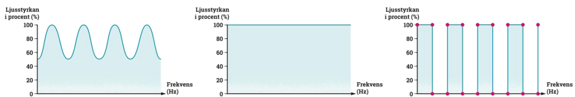
Figur 7.6 Olika ljuskällors ljusintensitetskurvor: sinuskurva och fyrkantsskurva. Fyrkantsskurvan ger upphov till ett svart randmönster över bilden när man tar foto med mobiltelefon (Illustration från Mynak (2021) Foto: Hillevi Hemphälä)
