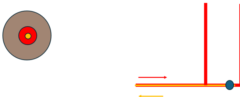
Figur 6 Varmvatteninstallation och invändig VVC i horisontella ledningar i källare.
