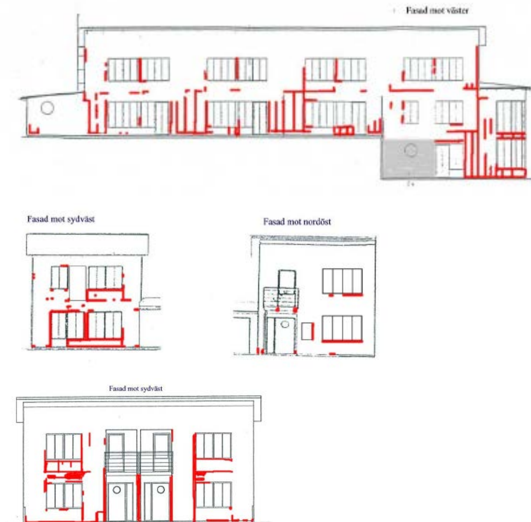
Figur 4.1 Exempel på skadornas utbredning efter friläggning in till träregelstommen (flerbostadshus). Röd färg markerar synlig mikrobiell påväxt eller rötskador. Grå färg markerar betongstomme (från Jansson 2011 RISE)
