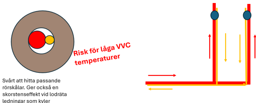
Figur 5 Varmvatteninstallation och VVC samisolerade i horisontella och vertikala ledningar.
