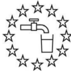
Figur 3.1 Symbol som tillverkaren ska märka produkter med efter att det bedömts att produkten är i överensstämmelse med ställda krav.
