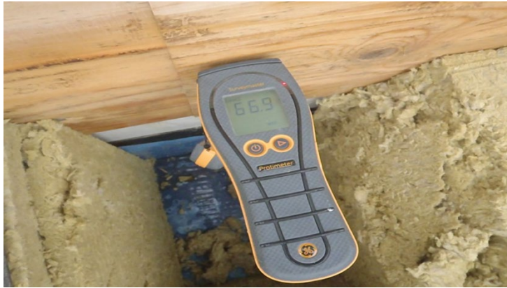
Figur 3.1.1 Uppfuktad plywood i ett kompakttak. (Foto: Eva Gustafsson)
