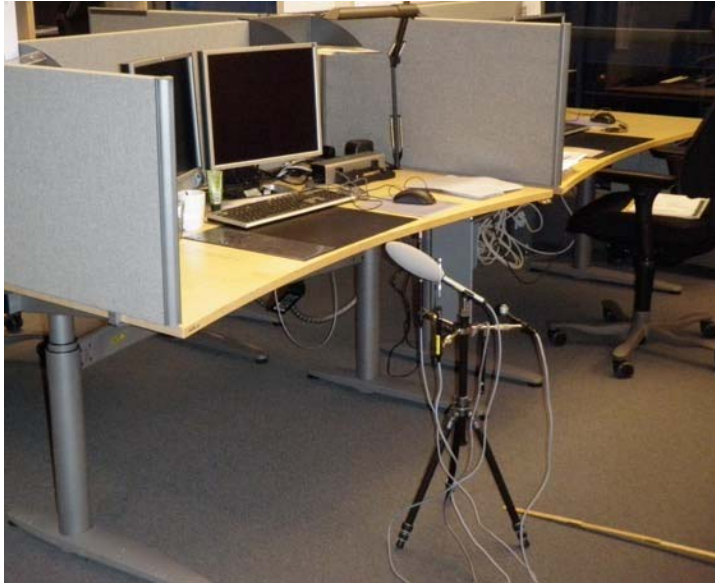
Figur 6.2 Instrument som används för mätning av termisk komfort (Bild från RISE/SP).
